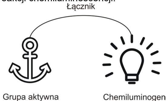
Schemat 1. Schemat budowy znacznika chemiluminescencyjnego
